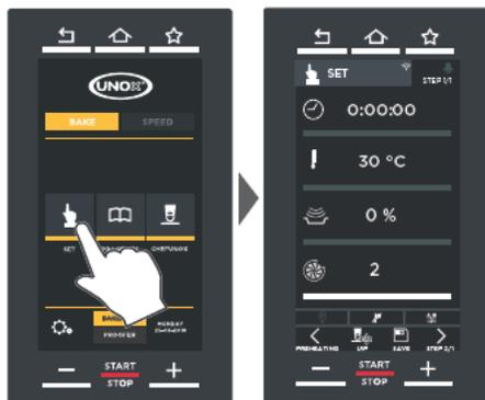
08 ▶ Si la page-écran du mode SPEED (cuissons rapides) apparaît lors de l'allumage de l'appareil, cela signifie que ce mode est le dernier à avoir été utilisé avant l'arrêt de l'appareil.
